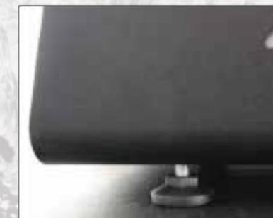
La regolazione del piede di appoggio permette di adattare la macchina su qualsiasi superficie.
